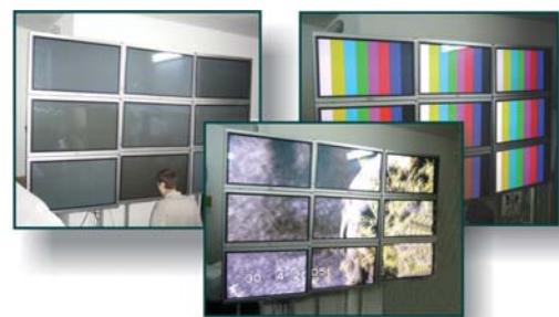
Рис. 2. Испытания делителя изображения DVC209i при создании видеостены из 9 плазменных панелей (матрица 3×3)
