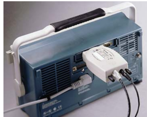
Рис. 6. Подключение коммуникационных модулей к осциллографу
