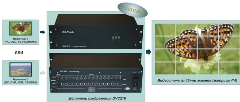
Рис. 1. Создание видеостены из 16 плазменных панелей (матрица 4×4) с использованием делителя изображения DVC216
