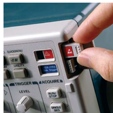
Рис. 7. Установка дополнительных модулей в осциллографы серии TDS3000B
