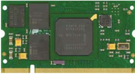
Рис. 2. Процессорный модуль Colibri
